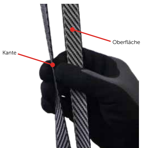
Inspektion der Gurtbandoberflächen
