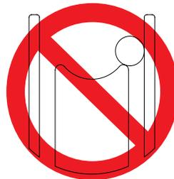
*Relación correcta entre el tamaño de la polea y el espacio de la placa lateral - Relación incorrecta del tamaño de la polea (excesivo espacio de la placa lateral)*
