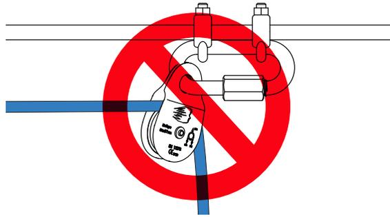
*Umlenkrolle mit falscher Ausrichtung*
